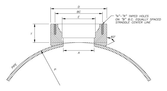
MECHANICAL JOINT (TMJ) WELDED BOSS
